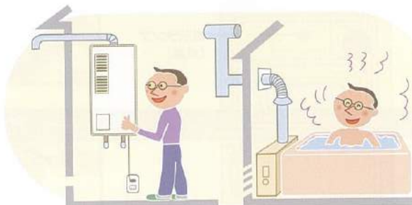
半密閉燃焼式 ガス瞬間湯沸器及びガスふろがま
